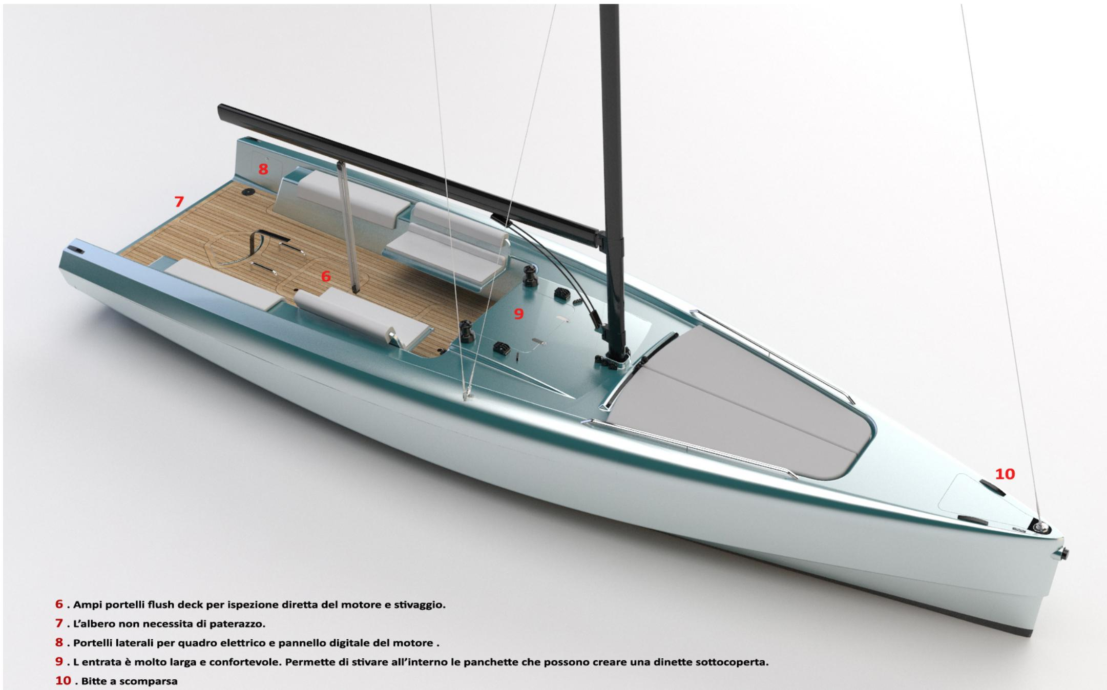
**6 .** Ampi portelli flush deck per ispezione diretta del motore e stivaggio.
